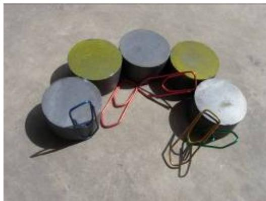
Photos : Piquets et aimants de géomètre
